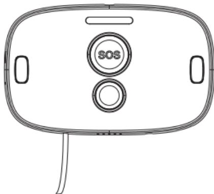
PB236 一款紧急呼叫器，适用于居家和机构养老场景。您可以将其固定在卧室床旁、卫生间、客厅灯区域墙上。通过拉绳（或按 SOS）将报警信息发送给服务器，通过服务器再传输到各个应用终端。它也可以和蜂鸣器一起工作，当有人呼叫的时候，蜂鸣器就会发出警报。
